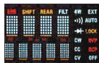
3-х цветный двухстрочный дисплей на базе VFD матрицы (5x7 точек)
