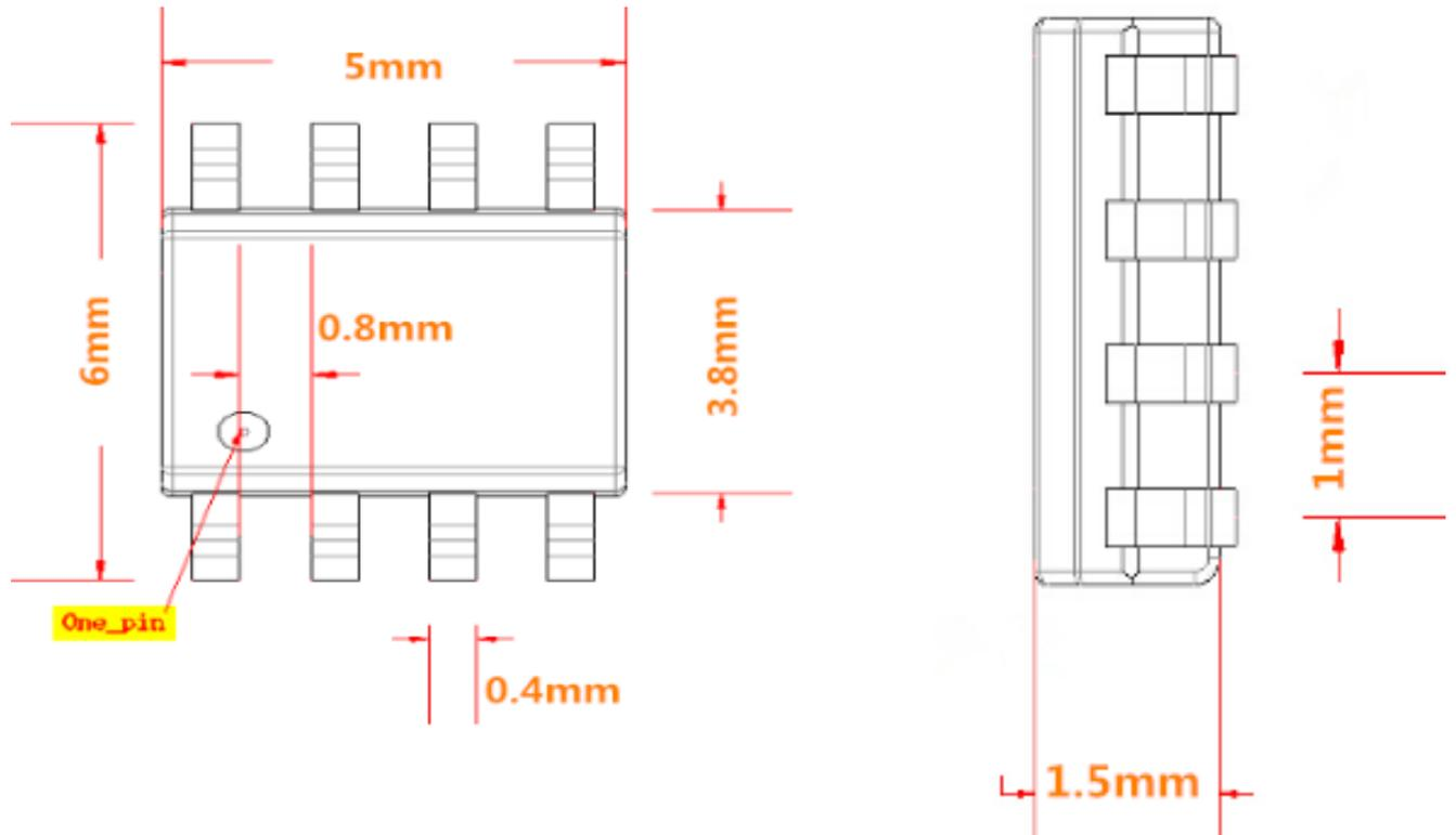
如没有特别提示，所有尺寸标注均为：（毫米） 公差： $\pm 0.09\text{mm}$
