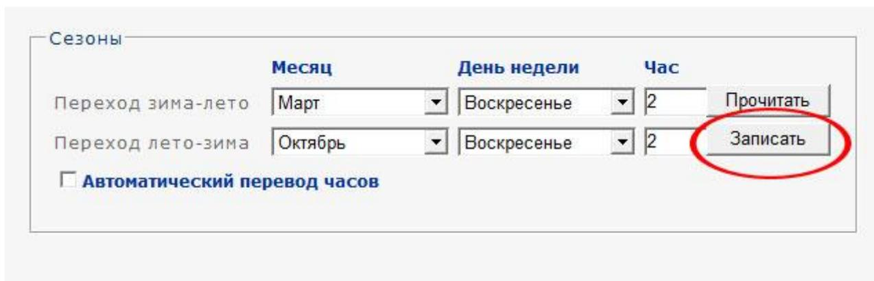
6. Проверить результат программирования прочитав из счетчика записанные параметры – кликнув по кнопке «Прочитать»
