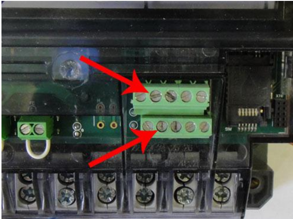
Рис. 14 Клеммы счетчика Меркурий 230 для подачи питания интерфейса
