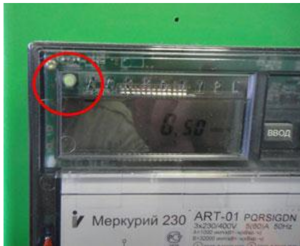
Рис. 24 Индикатор состояния встроенного GSM модема на счетчике Меркурий 230.
