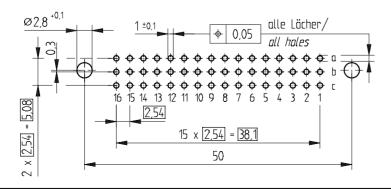
Tauchlötaschluß 0,65 x 0,3 mm / salder terminal 0,65 x 0,3 mm Isolierwerkstoff / hausing material : PBT GF30
