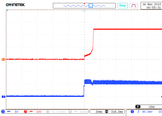
Рис. 19. Установление U_{\text{ВЫХ.НОМ}} с момента подачи ДУ (соединение выводов «ВКЛ» и «-ВХ»).
