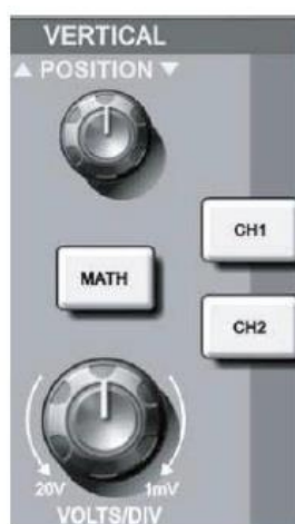
Рисунок 1-6 Зона управления вертикальной разверткой на передней панели
