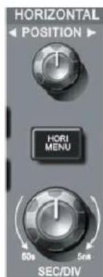
Рисунок 1-7 Зона управления горизонтальной разверткой на передней панели
