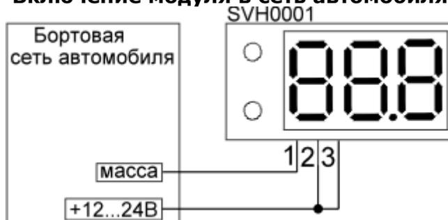
**Пример включения модуля SVH0001UB с модулем регулируемого стабилизатора EK-2596**
