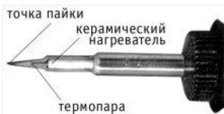
Паяльные жала фирмы ERSA известны высоким качеством и доступными ценами. Особая многослойная структура жал (5-7 слоев) повышает их долговечность и теплопроводность, а размещение керамического нагревателя с термосенсором внутри полого жала в непосредственной близости от точки пайки является условием высочайшей термостабилизации.
