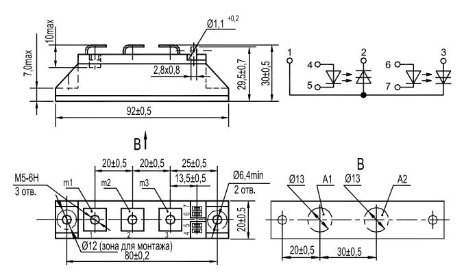
A1, A2 – области контроля температуры корпуса модуля; m1, m2, m3 – контрольные точки измерения импульсного напряжения в открытом состоянии
