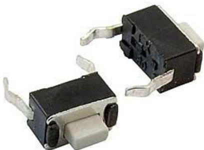
Тактовая кнопка RUICHI IT-0350, 6x3x5 мм, OFF-(ON), 50 мА, 12 В, 100 мОм, пайка в плату – это разновидность простейших механических выключателей, обеспечивающая замыкание контактов (без фиксации) только при наличии давления на поверхность штока (толкателя).
