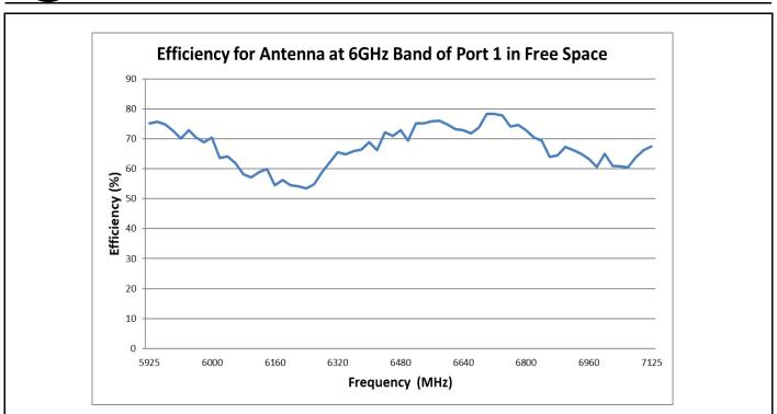
FIGURE 4.4.3 EFFICIENCY OF ANTENNA AT 6GHZ BAND OF PORT 1 IN FREE SPACE
