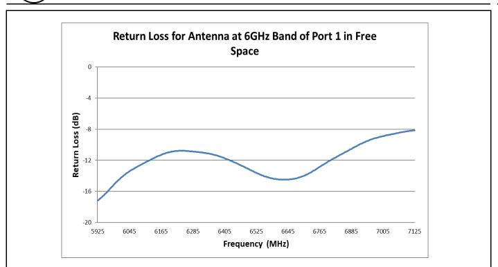
FIGURE 4.3.3 RETURN LOSS OF ANTENNA AT 6GHZ BAND OF PORT1 IN FREE SPACE
