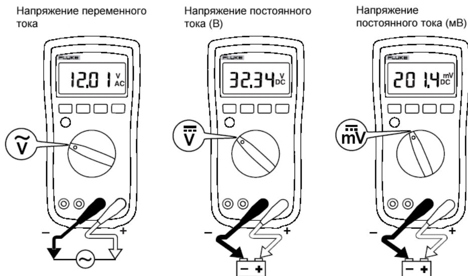
Рисунок 1. Измерение напряжения переменного и постоянного тока
