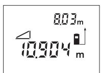
A második mérés befejezése után a készülék automatikusan kiszámítja a **B** távolságot. Az utolsó egyedi mérés eredménye a kijelző alsó részén, a **B** végeredmény pedig fent látható.
