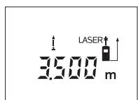
Proces pomiaru rozpoczyna się po naciśnięciu przycisku pomiaru **12**. Poruszać urządzeniem pomiarowym dotąd, aż u dołu wyświetlacza ukaże się żądana odległość.
