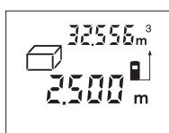
Pēc trešā mērījuma beigām tilpuma mērījuma rezultāts tiek automātiski aprēķināts un parādīts uz displeja. Pēdējā atsevišķā mērījuma rezultāts parādās uz displeja apakšējā indikatora, bet aprēķinātā tilpuma vērtība ir redzama uz indikatora displeja augšējā daļā.
