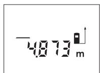
За насочване на лазерния лъч натиснете еднократно бутона «Измерване» **12**, а за измерване го натиснете повторно.
