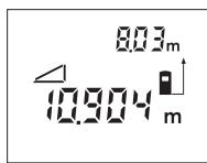
Pēc otrā mērījuma beigām tiek automātiski aprēķināts attālums **B**. Pēdējā atsevišķā mērījuma vērtība parādās uz displeja apakšējā indikatora, bet aprēķinātā attāluma **B** vērtība ir redzama uz indikatora displeja augšējā daļā.
