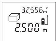
Pärast kolmanda mõõtmise teostamist arvutatakse ruumala automaatselt välja ja kuvatakse ekraanile. Viimase üksiku mõõtmise väärust näidatakse ekraani alumises osas, lõppulemust ülemises osas.
