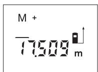
Stlačte tlačítko přičítání k paměti **2**, aby se aktuální naměřená hodnota – podle aktuální měřicí funkce hodnota délky, plochy nebo objemu – uložila do paměti. Jakmile se hodnota uložila, objeví se na displeji „**M**“, znak „+“ za ním krátce zabliká.
