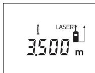
Lai uzsāktu mērīšanu, nospiediet mērīšanas taustiņu **12**. Pārvietojiet mērinstrumentu, līdz displeja apakšējā daļā parādās vēlamā attāluma vērtība.
