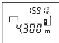
Po zakończeniu drugiego pomiaru, powierzchnia zostanie automatycznie obliczona i ukazany wynik. Wynik ostatniego pomiaru jednostkowego ukazany jest u dołu wyświetlacza, wynik końcowy u góry.
