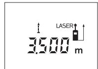
Щоб розпочати вимірювання, натисніть на кнопку вимірювання **12**. Пересувайте вимірювальний пристрій до тих пір, поки внизу на дисплей не висвітиться необхідна відстань.
