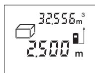
По окончании третьего измерения объем автоматически рассчитывается и высвечивается на дисплее. Последнее единичное измерение высвечивается на дисплее внизу, а конечный результат – вверху.
