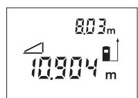
Після закінчення другого вимірювання відстань **B** розраховується автоматично. Останнє одниничне вимірюване значення відображається внизу на дисплей, кінцевий результат **B** відображається угорі.
