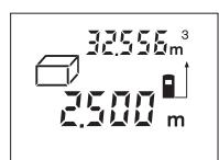
Після закінчення третього вимірювання пристрій автоматично розраховує об'єм і показує результат. Останнє одниничне вимірюване значення показується внизу на дисплей, кінцевий результат знаходиться угорі.
