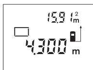
Pasibaigus antrajam matavimui, plotas apskaičiuojamas automatiškai ir parodomas ekrane. Paskutinė atskiro matavimo vertė rodama ekrano apačioje, o galutinis rezultatas viršuje.
