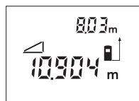
След приключване на второто измерване дължината на **B** се изчислява автоматично. Последно измерената дължина остава изобразена в долната част на дисплея, крайният резултат **B** – в горната.
