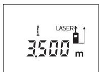
A mérési folyamat kiváltásához nyomja meg a **12** mérési billentyűt. Mozgassa el addig a mérőműszert, amíg a kijelző alsó részén meg nem jelenik a kívánt távolságérték.
