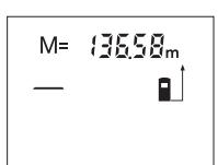
Aby wyświetlić wartość znajdującą się w pamięci należy nacisnąć przycisk edycji zapisanych danych **4**. Na wyświetlaczu ukaże się symbol „**M=**“. Po ukazaniu się zawartości pamięci „**M=**“ na wyświetlaczu, można naciskając przycisk dodawania wartości do zawartości pamięci **2** wartość tę podwoić lub naciskając przycisk odejmowania wartości od zawartości pamięci **8** wyzerować.
