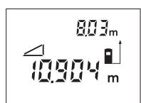
Po skončení druhého měření se automaticky vypočítá vzdálenost **B**. Poslední jednotlivá naměřená hodnota je na displeji dole, výsledek **B** nahoře.
