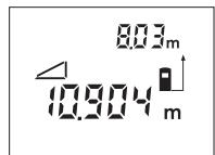
По окончании второго измерения автоматически высчитывается расстояние **B**. Последнее единичное измерение высвечивается на дисплее внизу, а конечное результат **B** – вверху.
