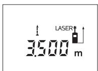
За стартиране на процеса на измерване натиснете бутона «Измерване» **12**. Придвижвате измервателния уред, докато в долната част на дисплея се изобрази желаното разстояние.
