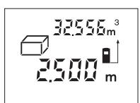
A harmadik mérés befejezése után a készülék automatikusan kiszámítja és kijelzi az térfogatot. Az utolsó egyedi mérés eredménye a kijelző alsó részén, a végeredmény pedig fent látható.
