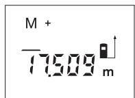
Dodawanie poszczególnych pomiarów – odległości, powierzchni lub objętości (w zależności od aktualnie ustawionej funkcji pomiaru) – do pamięci, odbywa się przez naciśnięcie przycisku dodawania wartości do zawartości pamięci **2**.
