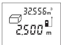
Po skončení třetího měření se objem automaticky vypočítá a zobrazí. Poslední jednotlivá naměřená hodnota je na displeji dole, výsledek nahoře.
