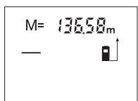
Stlačte tlačítko vyvolání paměti **4**, aby se v paměti uložená hodnota zobrazila. Na displeji se objeví „**M=**“. Pokud je na displeji zobrazen obsah paměti „**M=**“, pak jej můžete stlačením tlačítka přičítání k paměti **2** zdvojnásobit ev. stlačením tlačítka odčítání od paměti **8** stanovit na nulu.
