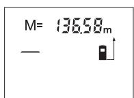
Для отображения сохраненного значения нажмите кнопку вызова из памяти **4**. На дисплее высвечивается «**M=**». При отображении на дисплее сохраненного значения «**M=**» Вы можете, нажав кнопку сложения **2**, умножить его на два или, нажав кнопку вычитания **8**, обнулить содержимое памяти.
