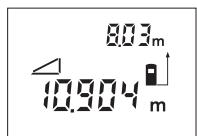
Nakon završenog drugog mjerena automatski će se izračunati udaljenost **B**. Zadnja pojedinačna izmjerena vrijednost nalazi se dolje na displeju, a krajnji rezultat **B** gore.
