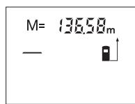
Stlačte tlačidlo na vyvolanie pamäte **4**, aby sa zobrazila hodnota, ktorá je uložená v pamäti. Na displeji sa zobrazí symbol pamäti „**M=**“. Keď sa na displeji zobrazí obsah pamäte „**M=**“, môžete ho stlačením pripočítavacieho tlačidla pamäte **2** zdvojnásobiť, resp. stlačením odpočítavacieho tlačidla pamäte **8** zredukovať na nulu (vynulovať).
