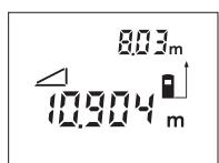
Po ukončení druhého merania sa vzdialenosť **B** vypočíta automaticky. Posledná nameraná jednotlivá hodnota sa zobrazí na displeji dole, konečný výsledok **B** je zobrazený na displeji hore.
