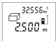
Po zakończeniu trzeciego pomiaru, powierzchnia zostanie automatycznie obliczona i ukazany wynik obliczeń. Wynik ostatniego pomiaru jednostkowego ukażany jest u dołu wyświetlacza, wynik końcowy u góry.
