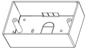
147X86x45mm BACK BOX TOLERANCE UNLESS OTHER SPECIFIED :± 0.15MM
