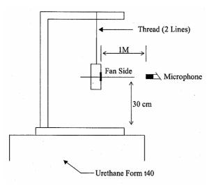
1 METER FROM MICROPHONE TO FAN INTAKE
