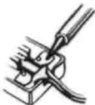
3. Нанесите на необходимую часть синтетический припой и расплавьте его паяльником.
