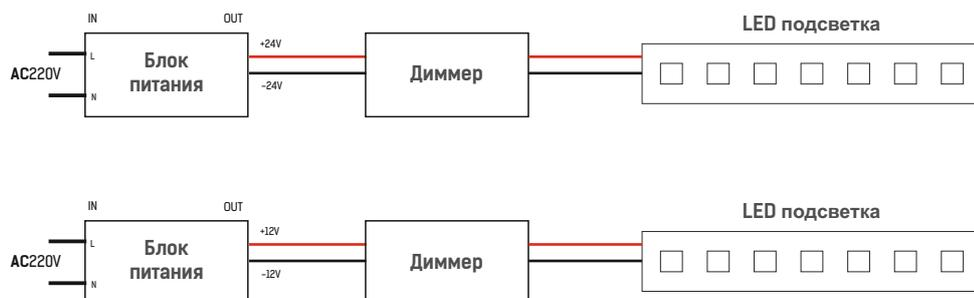
**ПРИМЕЧАНИЕ:** Обратите внимание, что данные типы контроллеров не имеют функции защиты от неправильного подключения. Все подключения производить без подачи питания согласно обозначениям маркировок выводов/площадок под пайку на печатной плате контроллеров.
