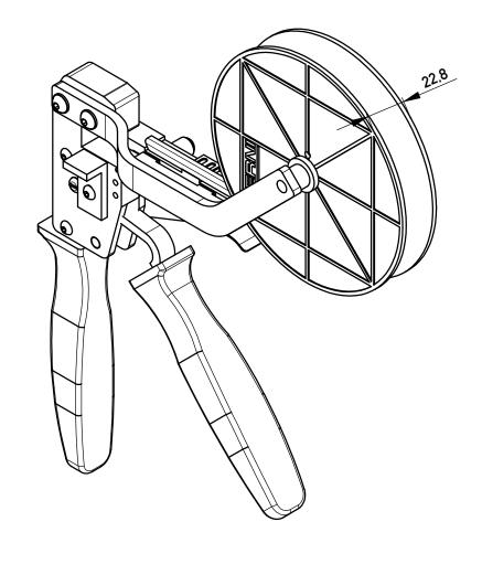
\* für Federkontakte AWG 20-22 \* for Female Contacts AWG 20-22
