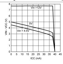
Figure 4. V<sub>CC</sub> vs. V<sub>IN</sub>
