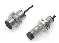
Индуктивные выключатели TD реагируют на приближение металлического объекта к их чувствительной части и не чувствительны к остальным материалам. Это увеличивает их защищенность от помех, например, введение в зону чувствительности выключателя рук оператора, эмульсии, воды, смазки и т.д. не приведет к ложному срабатыванию.
