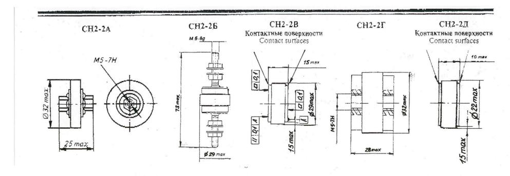
Предназначены для защиты от перенапряжений элементов и устройств различной радиоэлектронной и электротехнической аппаратуры в цепях постоянного, переменного и импульсного токов, а также для стабилизации и формирования напряжений.
