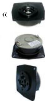
Головка 10ГДВ-6-25 является высокочастотной, диффузорной головкой с кольцевым магнитом и неэкранированной магнитной системой. В головке применено ферритовое кольцо марки М22РА-220к 85\*35\*15
