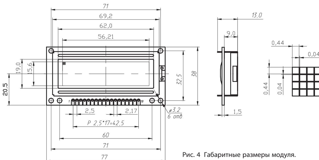
Рис. 4 Габаритные размеры модуля.
