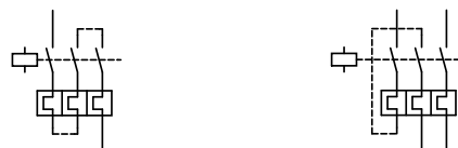
Abbildung 4: Verdrahtung des Motorschutzrelais für den Schutz von Wechselstrom- oder Gleichstrommotoren (Reihenschaltung der Bimetallauslöser)
