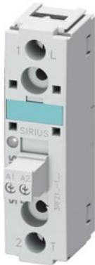
Полупроводниковое реле, 1-фазное, 3RF2 Установочная ширина 22,5 мм, 20 A 48–460 В/24 В DC Винтовые зажимы
