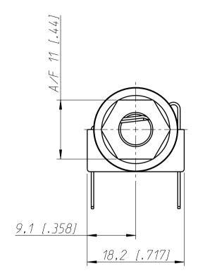
Frontplattenausschnitt (Rückseite) Panel cut out (rear side)
