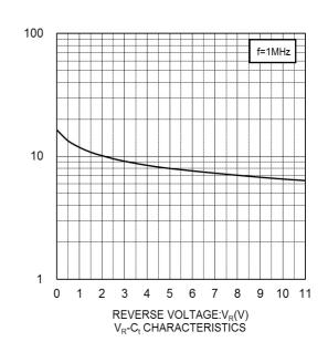
CAPACITANCE BETWEEN TERMINALS:C<sub>t</sub>(pF)
