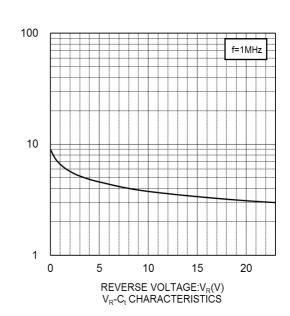
CAPACITANCE BETWEEN TERMINALS:C<sub>t</sub>(pF)
