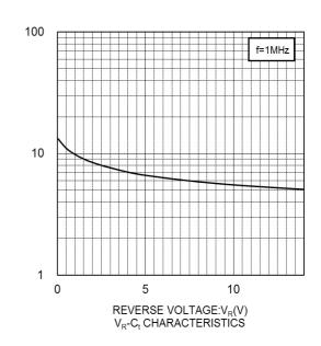
CAPACITANCE BETWEEN TERMINALS:C<sub>t</sub>(pF)
