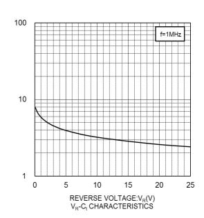
CAPACITANCE BETWEEN TERMINALS:C<sub>t</sub>(pF)
