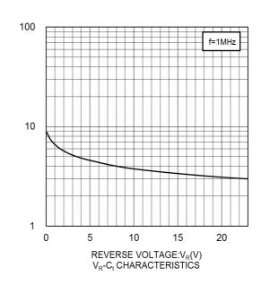
CAPACITANCE BETWEEN TERMINALS:C<sub>t</sub>(pF)
