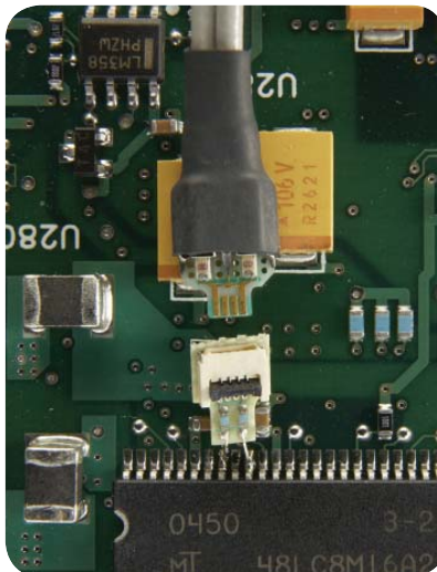
InfiniiMax ZIF tip soldered on board
