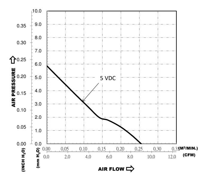
\*TEST CONDITION: INPUT VOLTAGE----OPERATION VOLTAGE
