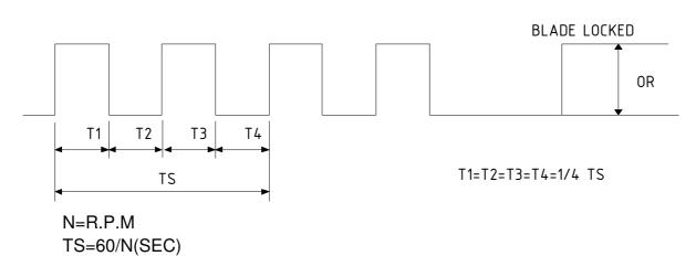
\*VOLTAGE LEVEL AFTER BLADE LOCKED \*4 POLES
