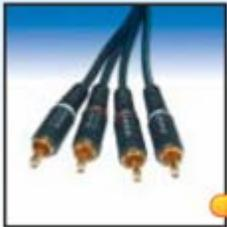
Два канала: видео-канал моно аудио-канал, либо стерео аудио-канал. Пластиковые неразборные наконечники. Разъёмы покрыты золотом. Медный многожильный проводник в ПВХ изоляторе. Предназначен для соединений в аудио-видеосистемах.
