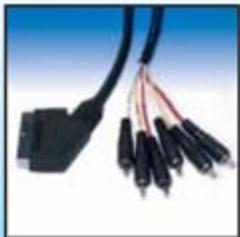
Кабель межблочный SCART вилка на 6RCA вилка. Воспроизведение и запись: видео-канал стерео аудио-канал. Общий экран. Пластиковые неразборные наконечники. Медный многожильный проводник в ПВХ изоляторе. Предназначен для соединений в аудио-видеосистемах.
