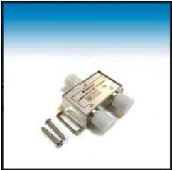
Высокочастотный (5-1000 МГц) разветвитель (сплиттер) на 2 направления. Входы и выходы под F-разъем. Металлический неразборный корпус. Используется для разветвления ТВ-кабелей. Поставляется в комплекте с шурупами для крепления к стене.
