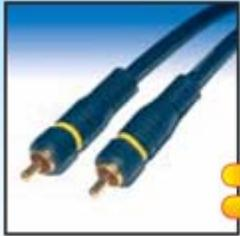
Волновое сопротивление 75 Ом. Пластиковые неразборные наконечники. Разъёмы покрыты золотом. Медный многожильный проводник в ПВХ изоляторе. Предназначен для соединений в аудио-видеосистемах.
