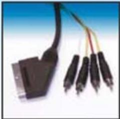
Кабель межблочный SCART вилка на 4RCA вилка. Воспроизведение и запись: видео-канал моно аудио-канал или стерео аудио-канал. Общий экран. Пластиковые неразборные наконечники. Медный многожильный проводник в ПВХ изоляторе. Предназначен для соединений в аудио-видеосистемах.
