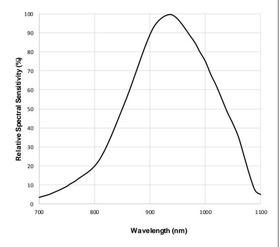
Testcondition: Ee= 0,5 mW/ cm<sup>2</sup>; VCE=5V
