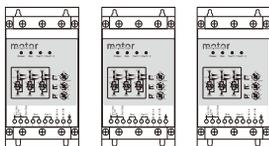
Если два или более устройств плавного пуска установлены горизонтально рядом друг с другом, расстояние между устройствами плавного пуска составляет не менее 50 мм.
