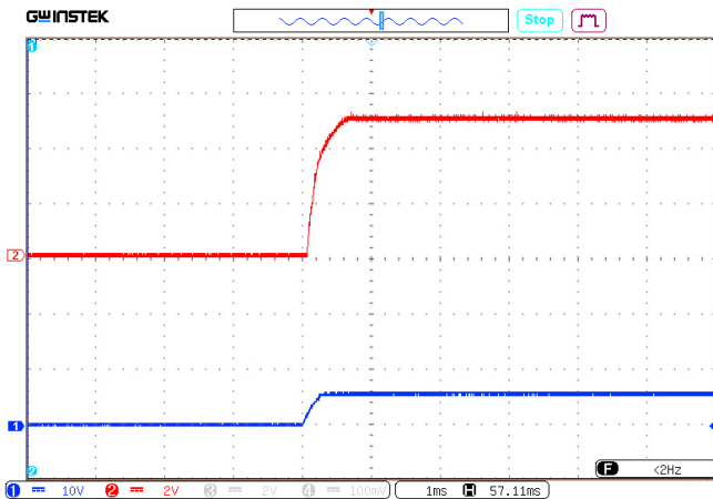
Рис. 11 (а). Осциллограмма установления выходного напряжения с момента подачи команды дистанционного управления.
