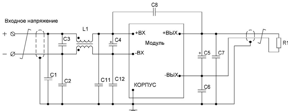
Рис. 2. Типовая схема подключения VDN10.
