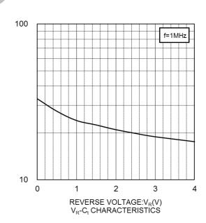
CAPACITANCE BETWEEN TERMINALS:C<sub>f</sub>(pF)
