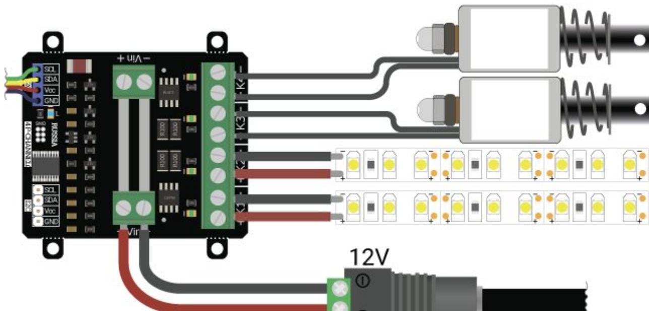
При нагрузках близких к максимальным рекомендуется установка радиаторов и(или) использование активного охлаждения. Например, можно установить один [радиатор 43x8x10](#).
