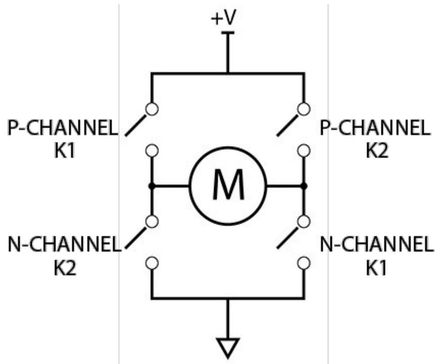
Следует избегать одновременного включения двух ключей с одной стороны - это приведёт к короткому замыканию источника питания. Ниже изображено подключение линейного толкателя к модулям. Каждый вывод мотора толкателя должен быть подключён и к N-каналу и к P-каналу.
