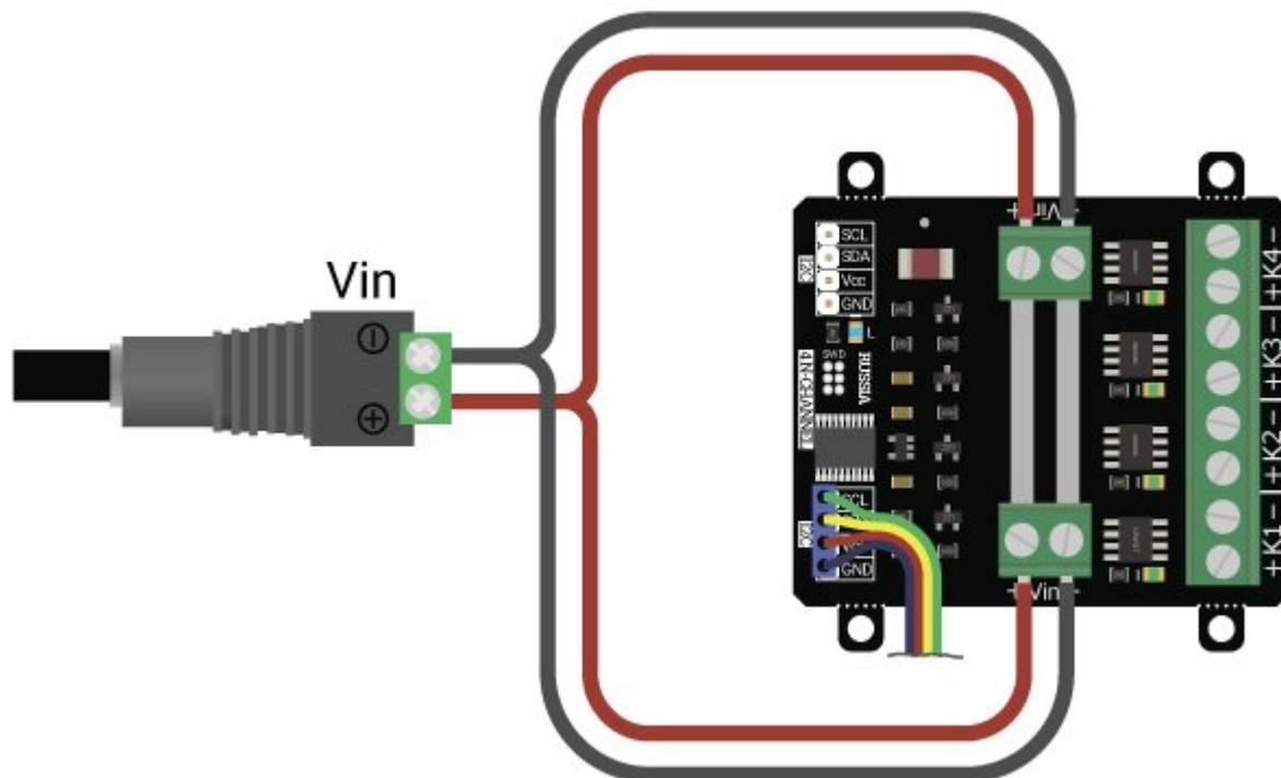
При нагрузках более 5 ампер на канал рекомендуется установка радиаторов и(или) использование активного охлаждения. Например, можно установить один [радиатор 43x8x10](#) или два [радиатора 22x9x6](#).
