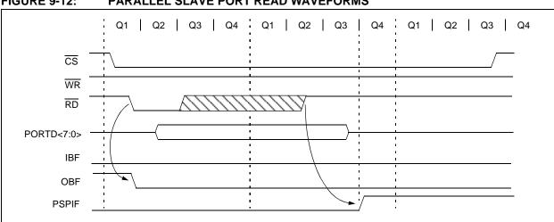
FIGURE 9-12: PARALLEL SLAVE PORT READ WAVEFORMS
