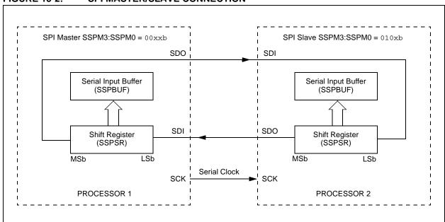
FIGURE 15-2: SPI MASTER/SLAVE CONNECTION
