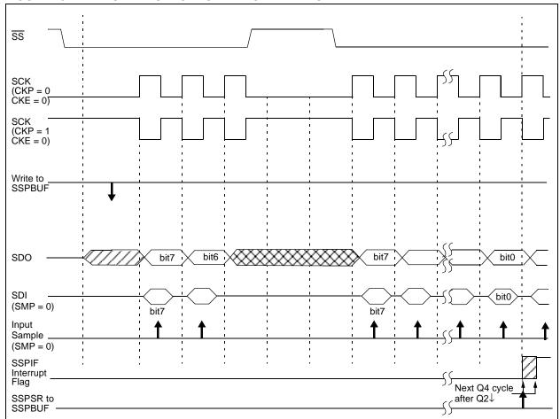
FIGURE 15-5: SPI MODE WAVEFORM (SLAVE MODE WITH CKE = 0)
