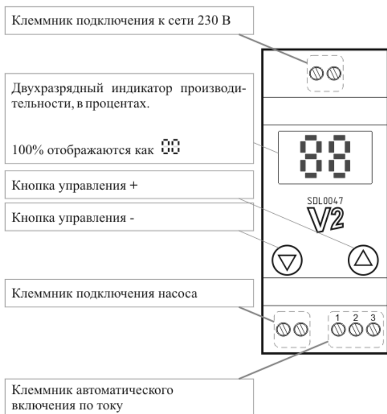
Рис. 6. SDL0047 V2, внешний вид и назначение клемм*.
