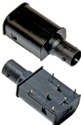
Berührungsgeschützte BNC-Winkelbuchse für die Leiterplattenmontage, berührungsgeschützt gemäss IEC/EN 61010-1. Die Buchse wird direkt auf Platinen gelötet. Die 90°-Abwicklung sorgt für minimale Kraftübertragung durch die eingesteckte Messleitung auf die Platine.
