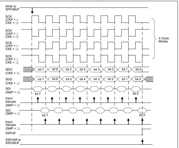
FIGURE 30-6: SPI MODE WAVEFORM (HOST MODE)
