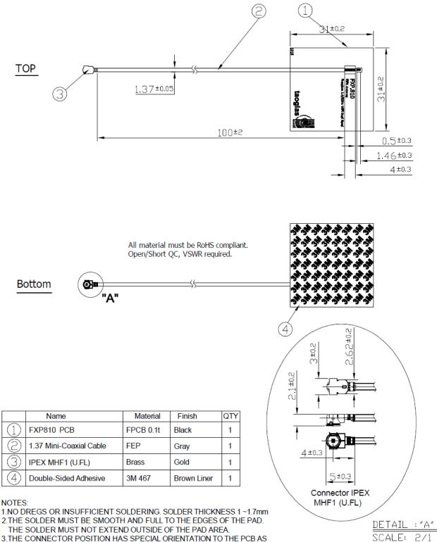
3. THE CONNECTOR POSITION HAS SPECIAL ORIENTATION TO THE PCB AS PER DRAWING.
