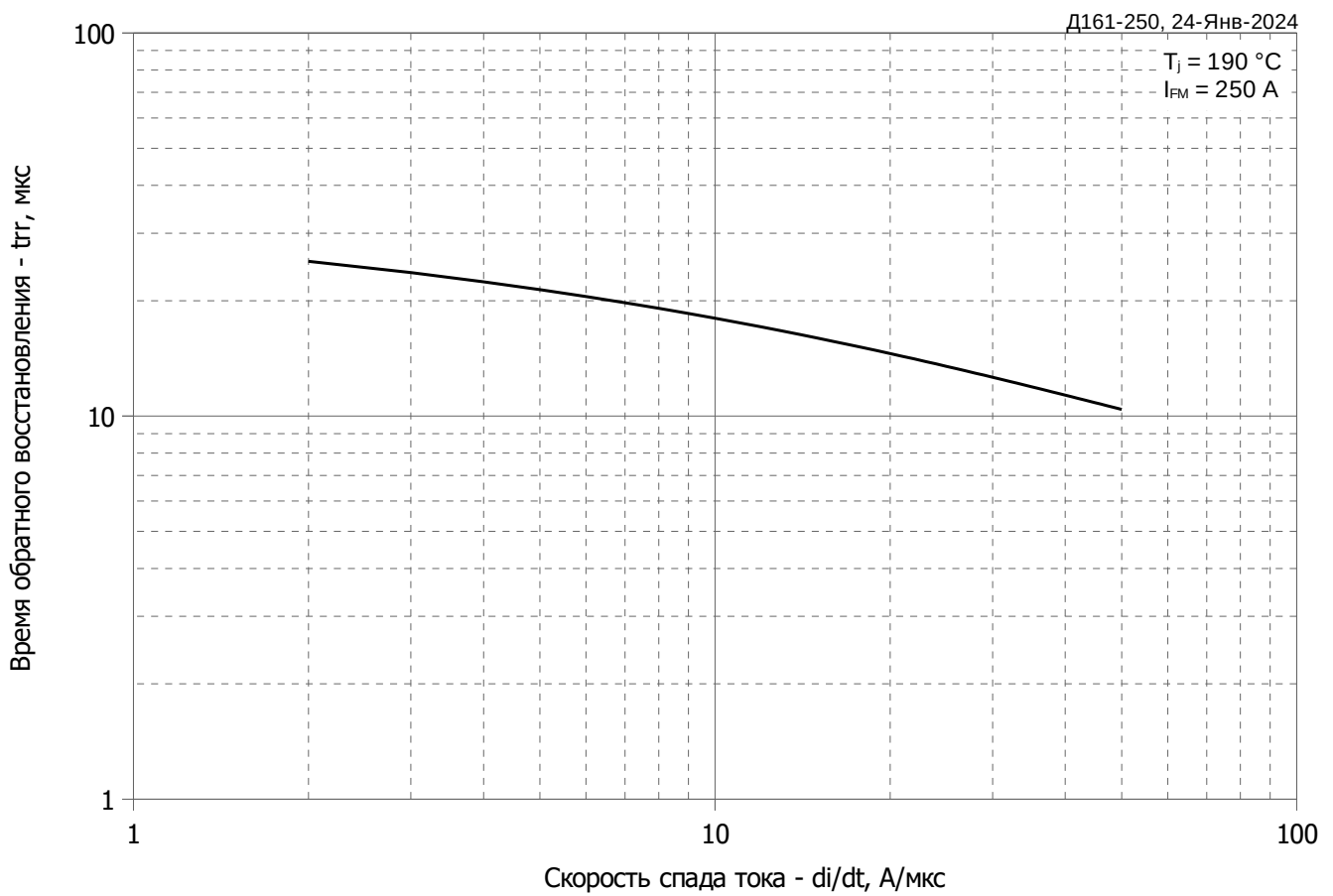
Рис. 6 - Зависимость максимального времени обратного восстановления t_{rr} от скорости спада прямого тока di_R/dt (по ГОСТ 24461, хорда 25%)
