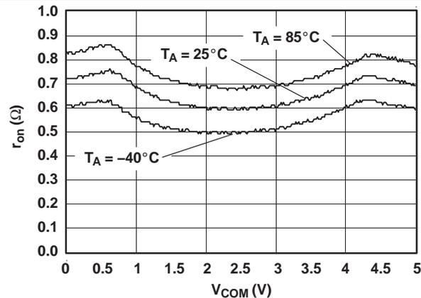
Figure 27.  $r_{on}$  vs  $V_{COM}$  ( $V_+ = 5\text{ V}$ )
