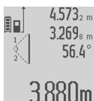
По окончании измерения результат для искомого отрезка «X» отображается в строке результата **с**. Значения измерения для отрезков «1», «2» и угла «α» отображаются в строках измеренных значений **а**.
