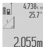
По окончании измерения результат для искомого отрезка «**X**» отображается в строке результата **с**. Значения измерения для отрезка «**1**» и угла «**α**» отображаются в строках измеренных значений **а**.
