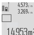
По окончании второго измерения значение площади автоматически рассчитывается и высвечивается в строке результата **с**. Отдельные измеренные значения отображаются в строках измеренных значений **а**.
